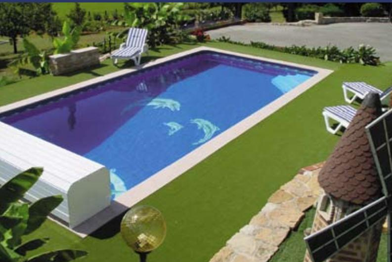
*Mit PVC-Dichtungsbahnen lassen sich Schwimmbäder schnell faltenfrei auskleiden: eine sehr nachhaltige Gestaltungslösung, die über 20 Jahre lang hält und besonders pflegeleicht ist.*
